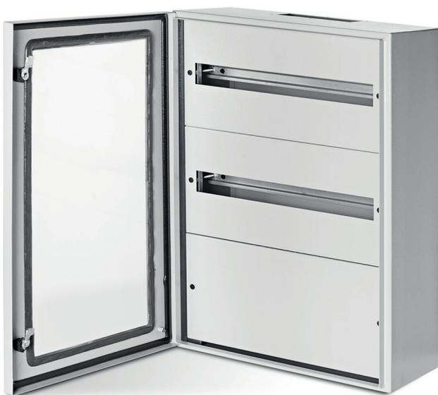
Cassetta in lamiera spessore 12-15/10, completa di porta frontale, in lamiera 15/10 con alloggiamento per lastra trasparente in PVC spessore 3 mm e guarnizione di tenuta.
